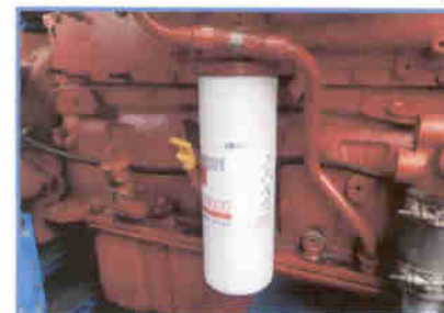
RTG 002 วันที่ 27 มิถุนายน 2566 ตรวจสอบภาพ 250 ชั่วโมง ครั้งที่ 2 เปลี่ยนถ่ายน้ำมันเครื่อง ก่อนทำ
