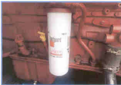
RTG 002 วันที่ 15 มิถุนายน 2566 ตรวจสภาพ 250 ชั่วโมง ครั้งที่ 1 เปลี่ยนถ่ายน้ำมันเครื่อง ก่อนทำ
