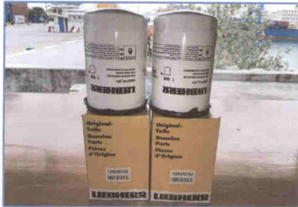
MHC 01 วันที่ 27 เมษายน 2566 เปลี่ยนกรองน้ำมันดีเซล หลังทำ
