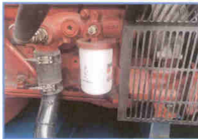
RTG 002 วันที่ 15 มิถุนายน 2566 ตรวจสภาพ 250 ชั่วโมง ครั้งที่ 1 เปลี่ยนถ่ายน้ำมันเครื่อง ก่อนทำ
